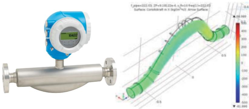
propio caudalímetro por presencia de aire o deposiciones de producto. Valores como la frecuencia de oscilación de los tubos, amplitud de la oscilación, o bien la corriente que alimentación a la bobina que hace oscilar el tubo/s, pueden monitorizarse para planear una estrategia de mantenimiento, o bien de análisis del propio proceso.
